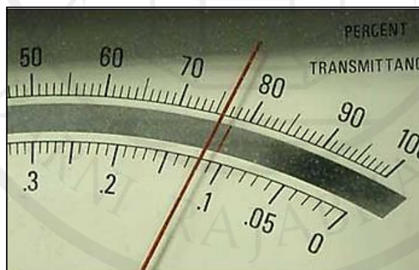
ภาพที่ 4.2 ลักษณะการเกิดความคลาดเคลื่อนพาร์แลกซ์จากเงาของอุปกรณ์ ที่ผิด (Muelaner, 2013)
