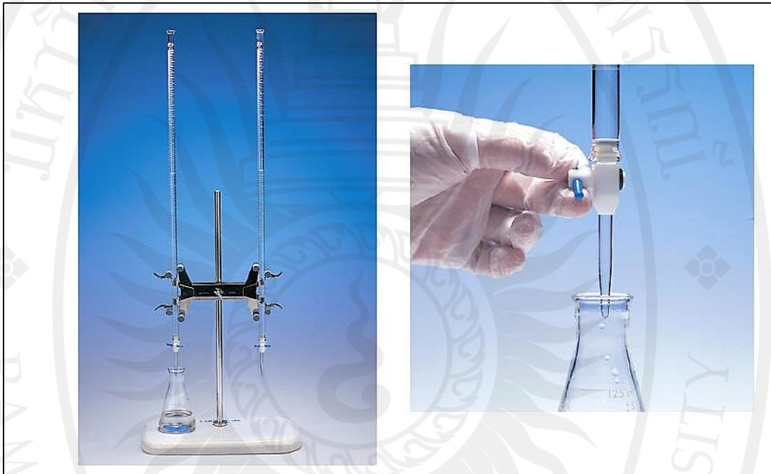
ภาพที่ 4.17 บิวเรตพร้อมอุปกรณ์ขาตั้ง ที่มา (Burette Using A Burette, n.d.)
