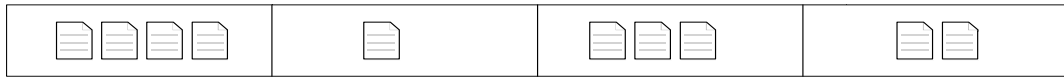
ภาพที่ 7.28 ปัญหา Internal Fragmentation แสดงการเก็บข้อมูลไม่เต็มหน้า เกิดพื้นที่สูญเปล่า
